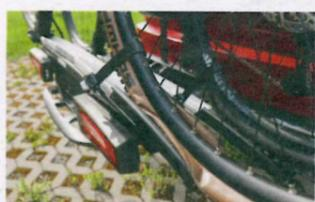
Kurze Riemen: Luft ablassen, um Rad zu befestigen
