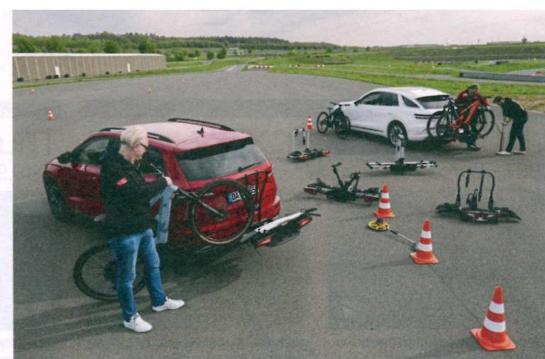
Für den Fahrradträgetest traten auf einer Versuchsstrecke sechs Träger an – erprobt mit zwei Autos, vier E-Bikes und drei Testern
