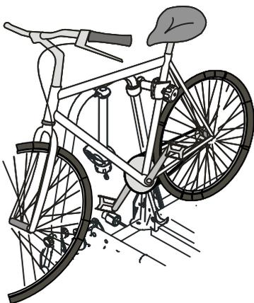
Fahrrad auf die Fahrradträger **6** aufsetzen. Knebelmutter des kurzen Abstandshalters aufdrehen, bis die gewünschte Breite des Fahrradrahmens erreicht ist. Abstandshalter an geeigneter Stelle des Fahrrades befestigen und Knebelmutter zudreuen, bis ein deutlich spürbarer Widerstand zu spüren ist.
