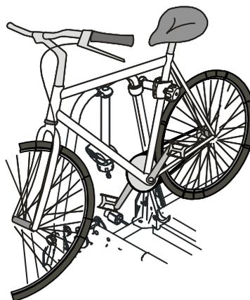
Knebelmutter 17 des kurzen Abstandshalter aufdrehen, bis die gewünschte Breite des Fahrradrahmens erreicht ist. Abstandshalter an geeigneter Stelle des Fahrrades befestigen und Knebelmutter 17 zudrehen, bis ein deutlich spürbarer Widerstand zu spüren ist.
