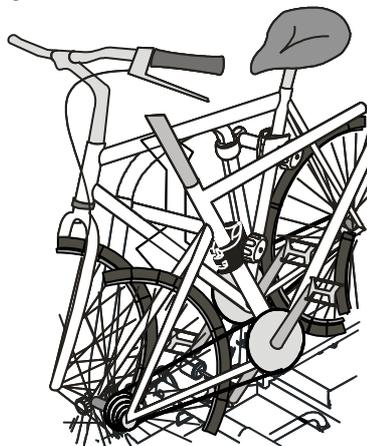
Das zweite Fahrrad wird entgegengesetzt (Lenker zur anderen Seite) positioniert und mit dem langen Abstandshalter, analog Punkt 3.1 - 3.3, befestigt.
