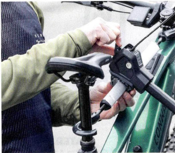
**Angriffsfläche:** Die ClickTop-Transporthilfe von Yakima ist eigentlich gedacht für unkonventionelle Rahmenformen oder Tiefeinsteiger. Aber auch für den Transport sensibler Carbon-Bikes ist diese Art der Befestigung eine schonende Alternative. Die Stange wird zwischen Vorbau und Sattelstütze geklemmt und dient als Ansatzpunkt für den Greifarm. Preis: 39 Euro.
