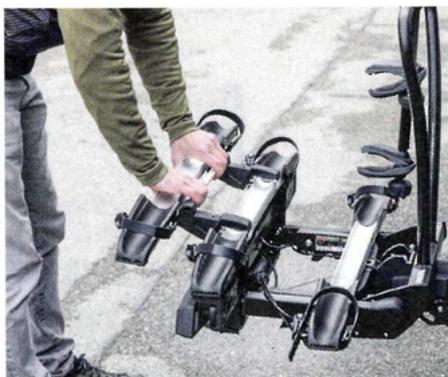
**Zuwachs:** Lässt sich der Fahrradträger um eine Schiene erweitern, kann man spontan auch mal einen weiteren Gast mit auf Tour nehmen. Achtung: Die Zusatzschienen sind bei der zulässigen Traglast meist etwas geringer ausgelegt. Preise: ab ca. 100 Euro.
