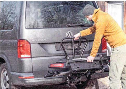
**Erleichternd:** Uebler und Yakima verzichten auf einen Klemmhebel. Klappt man ihre Schienen nach unten, werden die Träger automatisch an der Kupplung fixiert.
