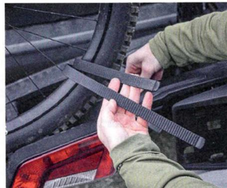
**Übermaß:** Große Akkus bedingen häufig auch wuchtige Unterrohre. Nicht alle Greifarme sind auf solche Übermaße ausgelegt. Toll, wenn sich die Halter über längere Ratschenbänder an die überdimensionierten Rohrdurchmesser anpassen lassen. Gleiches gilt für die Rastbänder an den Laufrädern.
