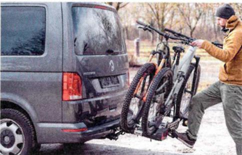
**Umständlich:** Der Klappmechanismus beim BuzzRack muss per Hand entriegelt und bedient werden. Alle anderen Hersteller setzen auf ein praktisches Fußpedal.
