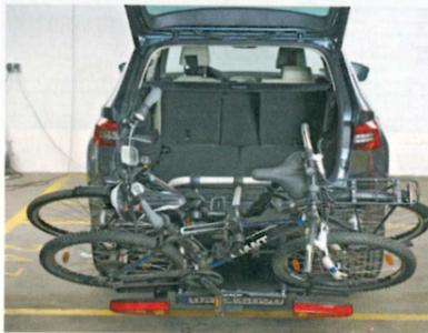
Abgeklappt: Die Räder bleiben auf dem Träger. Der Zugang zum Kofferraum ist frei; Gepäck lässt sich bequem ein- und ausladen
