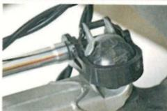
Freier Zugang: Der I-Racks lässt sich tief abklappen, macht den Weg zur Heckklappe frei. Die Klemmung auf dem Kugelkopf ist ungewöhnlich, hält den Träger aber fest
