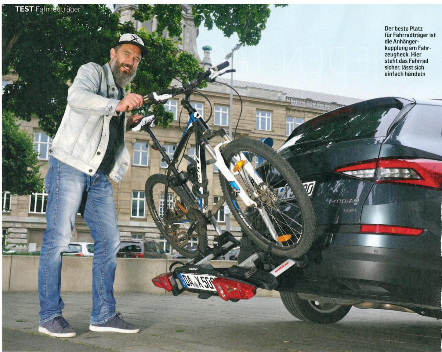
Der beste Platz für Fahrradträger ist die Anhängerkupplung am Fahrzeugheck. Hier steht das Fahrrad sicher, lässt sich einfach händeln
