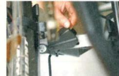
Funktional und stabil: Der Strada verzichtet auf komplizierte Details. Bevor man den Träger mit einem Fußtritt abklappen kann, ist der Sicherungsriegel (Bild unten) zu lösen
