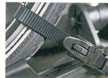
Der Träger von Westfalia besitzt moderne LED-Rückleuchten. Die Spannbänder mit Ratschen (Bild oben) sorgen für eine sichere Befestigung der Felgen
