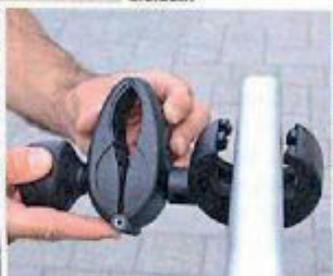
Der Uebler X21 S ist der Leichteste im Test. Er verwendet viele Kunststoffteile, die aber einen sehr soliden Eindruck machen. Sahnestückchen sind die Haltearme mit Einhandmechanismus, die am Trägerbügel schnell versetzt sind.
