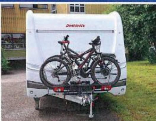
Der BC 70 von Westfalia überzeugt durch sehr kompakte Packmaße und eine durchdachte Befestigung auf dem Kugelkopf.
