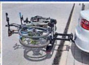
Der Abklappmechanismus wird unter dem Nummernschild entriegelt und der Träger knickt komplett ab. Die nicht optimal positionierbaren Fahrrad-Befestigungen halten auch in dieser Lage.
