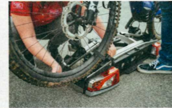
Zu kurze Schlaufen – andere Träger sind hier besser
