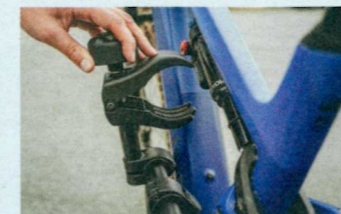
Abzug im Konzept: Der kurze Haltebügel macht Probleme
