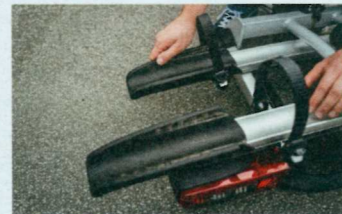
Die Radschienen lassen sich ein gutes Stück ausziehen
